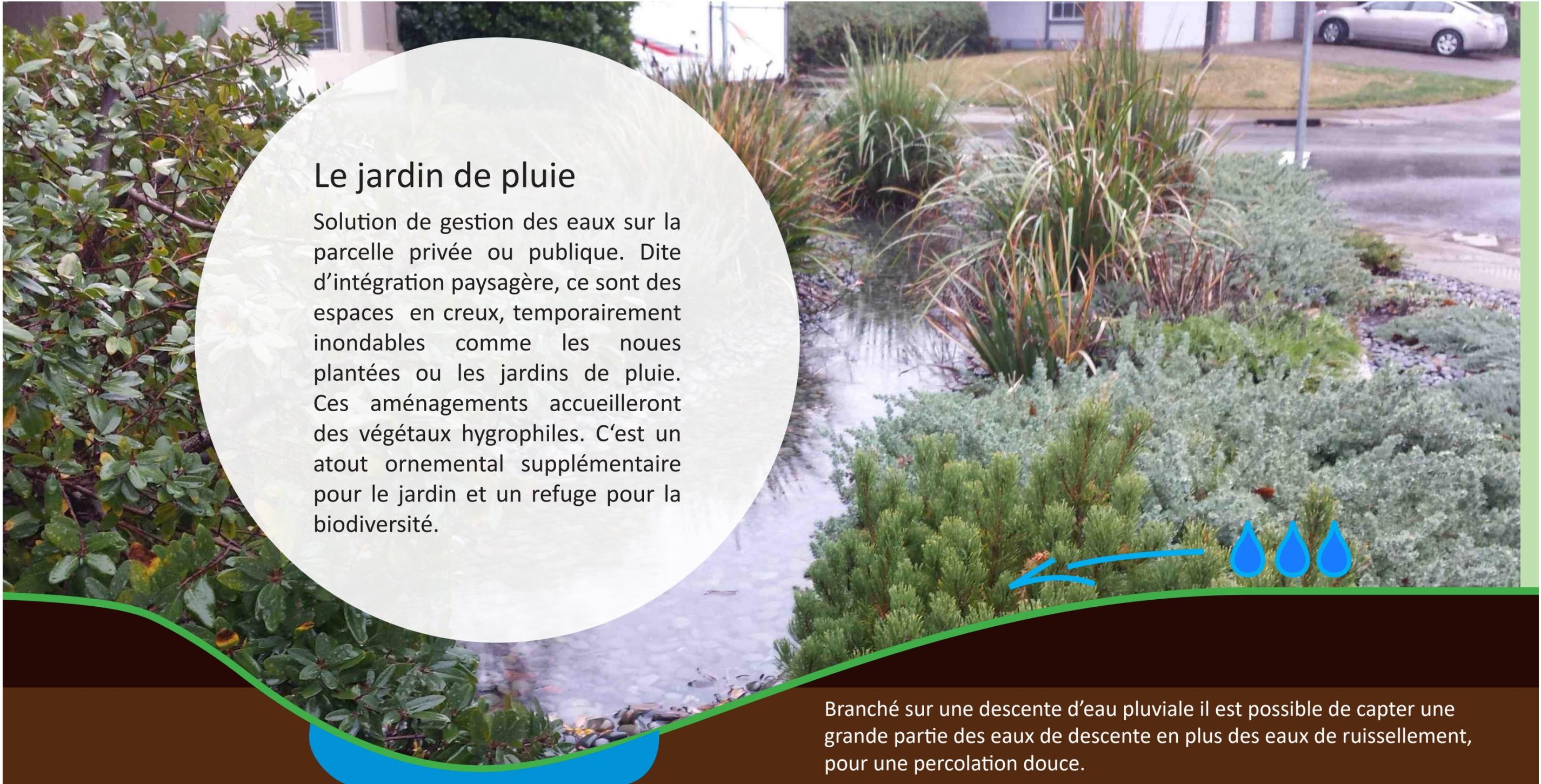
Branché sur une descente d'eau pluviale il est possible de capter une grande partie des eaux de descente en plus des eaux de ruissellement, pour une percolation douce.
